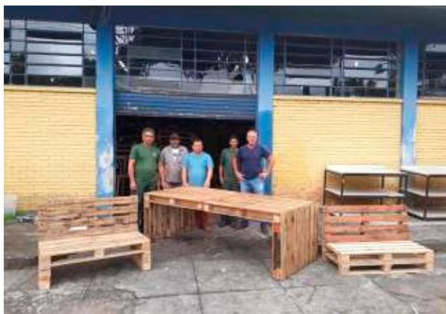
As estruturas brutas seguem um processo simples de produção que consiste no desmonte, corte, remontagem, parafusamento, pregagem, lixamento e impermeabilização, mantendo a aparência original da madeira que a compõem. A mesa central, que serve como móvel para o trabalho de *coworkers*, tem capacidade para até 12 assentos, 240 centímetros de vão livre, infraestrutura para rede elétrica, 150kg de equipamentos e durabilidade prevista de 20 anos.
